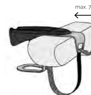
CupIN "B75" Max. Armlehnenbreite von 75 mm max. armrest width of 75 mm
