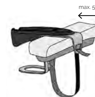
CupIN "B58" Max. Armlehnenbreite von 58 mm max. armrest width of 58 mm
